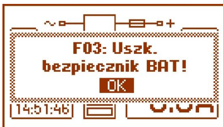
Rys. 9. Komunikat sygnalizujący przepalenie bezpiecznika na wyjściu AUX.
